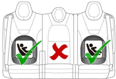
**메모** 대형 후향식 ISOFIX 어린이용 안전 시트를 장착하려면, 좌석을 완전히 뒤쪽 위치로 이동하고 해당 전면 좌석을 중간 트랙 위치로 앞으로 이동하고(가장 뒤쪽 위치에서 앞으로 최대 13cm), 좌석을 올리고(가장 낮은 위치에서 3 cm), 좌석을 뒤로 15도(또는 가장 앞쪽 위치에서 뒤쪽으로 10도) 기울여야 합니다.
