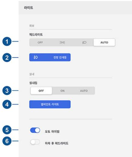
1. Model X를 시작할 때마다 실외등(헤드라이트, 테일라이트, 차폭등, 주차등 및 번호판 램프)이 **자동**으로 설정됩니다. **자동**으로 설정하면 어두운 상황에서 주행할 때 실외등이 자동으로 켜집니다. 다른 설정으로 변경할 경우 다음 주행 시 조명은 **자동** 설정으로 항상 되돌아갑니다.
