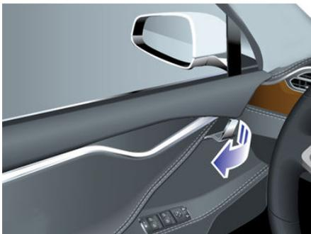
또한, Model X의 내부에 있을 때 터치스크린을 사용하여 도어를 열고 닫을 수 있습니다. **컨트롤릭 컨트롤**을 터치한 다음 열거나 닫으려는 도어를 선택합니다. 또한 Model X에 고급 업그레이드 패키지가 장착된 경우 브레이크 페달을 밟으면 운전석 도어가 자동으로 닫힙니다.
