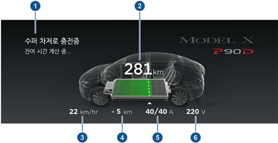
1. 충전 상태 정보. 예를 들어, Model X가 충전 중이면 현재 선택한 충전 수위에서 완충 수위가 될 때까지 걸리는 시간을 표시합니다. 충전 세션이 예정된 경우 충전이 시작될 때 표시됩니다.
