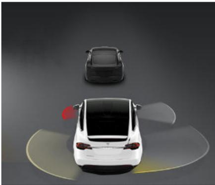
또한 차선 유지 어시스트는 시도하려는 차선 이탈이 적절하지 않을 때도 경고합니다. 방향 지시등을 작동하고 이동하려는 옆차선에서 차량 또는 물체가 감지되면, 계기판에 빨간색 차선 표시선이 표시되어 차량 또는 물체가 있다는 것을 나타냅니다. 차량 또는 물체가 더 이상 감지되지 않으면 차선 표시선이 정상으로 돌아옵니다.
