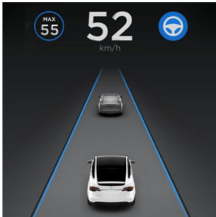
**메모** 전방에 차량이 없을 때 오토스티어를 시작하려면 차선이 뚜렷한 도로에서 최소 30km/h 속도로 운전 중이어야 합니다. 전방 차량이 감지된 경우 속도에 관계없이 정차 중인 경우라도(선행 차량에서 최소 150cm 떨어진 경우) 150km/h 미만의 속도에서 오토스티어를 시작할 수 있습니다.
